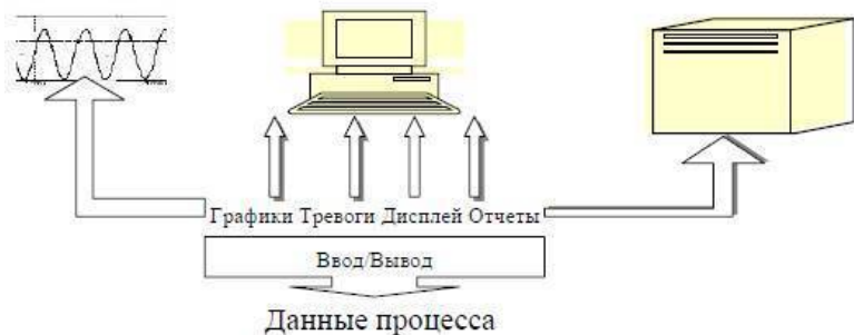
Рис. 5.5. Системная архитектура Citect
