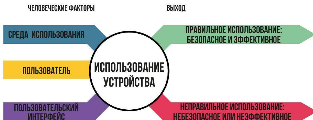
Рисунок 5.1 – Проектирование с учетом эксплуатационной пригодности/человеческого фактора приводит либо к безопасному и эффективному использованию, либо к небезопасному или неэффективному использованию. (Руководство FDA «Применение человеческого фактора и инженерии удобства использования к медицинским изделиям», февраль 2016 г)
