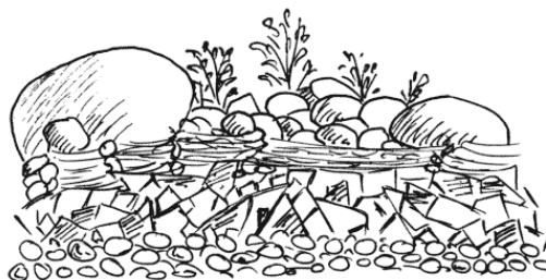
Рис. 2. Подпорная стенка из камней
