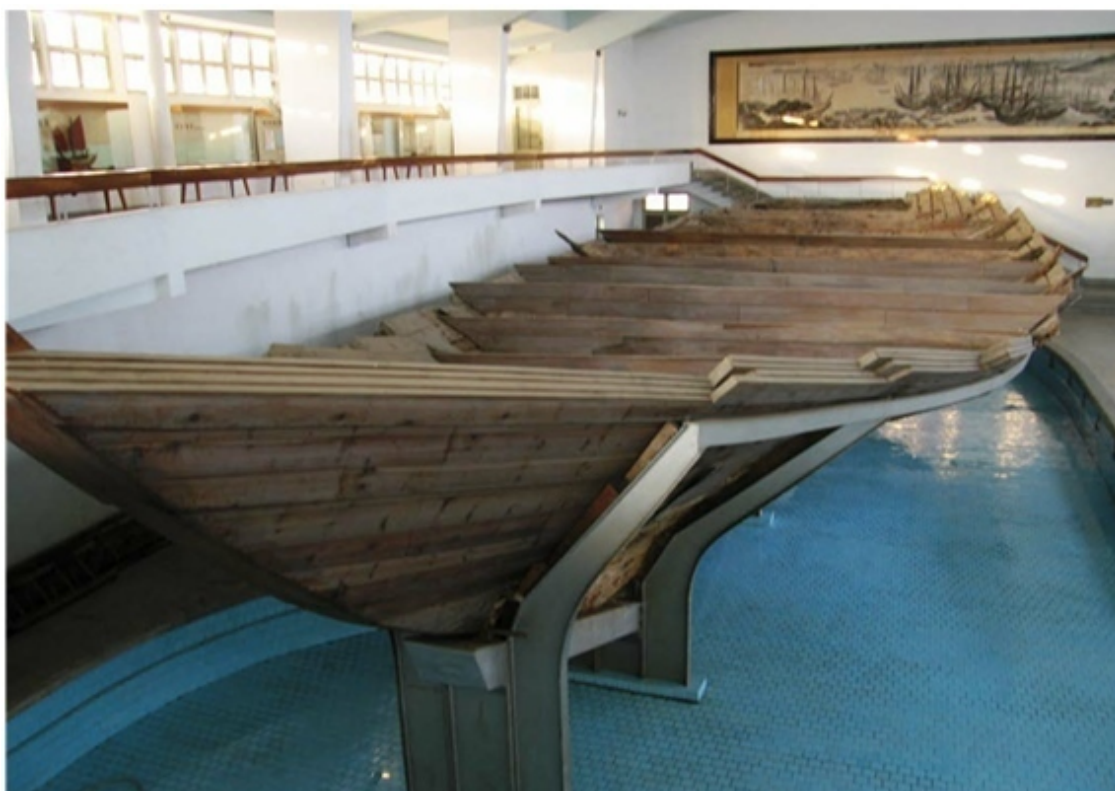
Китайская джонка, укрепленная водонепроницаемыми отсеками
