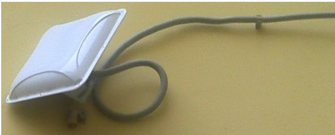
Неправильный монтаж GSM антенны
