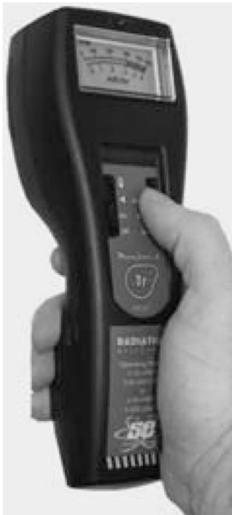
Универсальный детектор радиации 44ЕС (производства Montreal Biotech). Альфа-радиацию обнаруживает так же хорошо, как и все прочие ее виды. Работает от обычных батареек.
