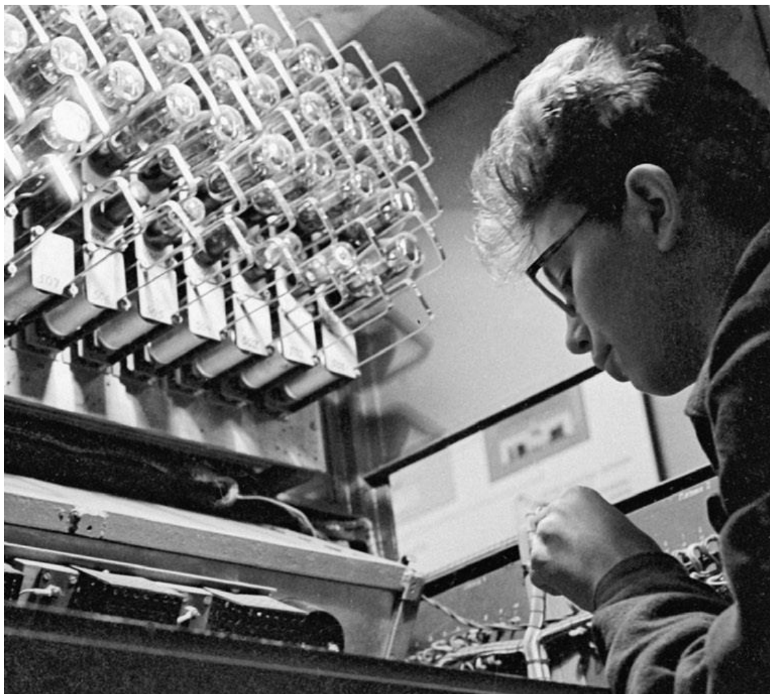
ЭВМ – устройство вычислительной машины М-3
